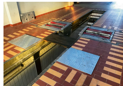
Gelenkspieltester für Fahrzeuge ab 3,5 Tonnen brauchen zwingend ein Fundament.
