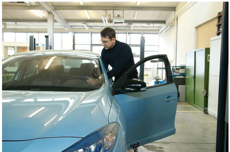
Lenkeinschlag durch Betätigen des Lenkrades, Fahrzeug ist auf Drehteller schwimmend gelagert, zurück auf die Mitte stellen; Lenkradspanner anlegen.
