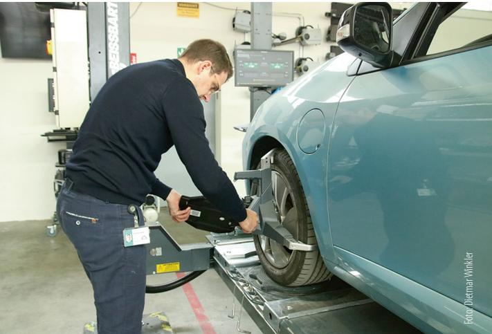
Anbringen der Targets an Vorder- und Hinterachse; Fahrzeug auf die Bühne, Vorderräder auf den Drehteller.
