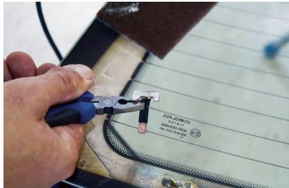
Beim Beladen kann es vorkommen, dass die Lötflanke von der Heckscheibe abreißt.
