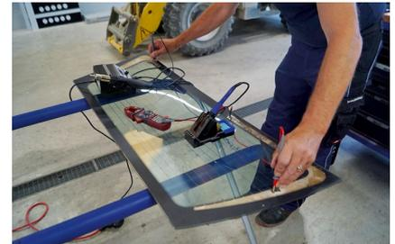
Zum Abschluss wird der Widerstand an den Anschlüssen der Heckheizung geprüft.
