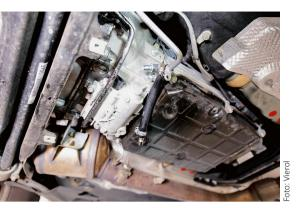
Die Adapter werden meist an der Getriebeöl-Kühlerzuleitung angeschlossen.
