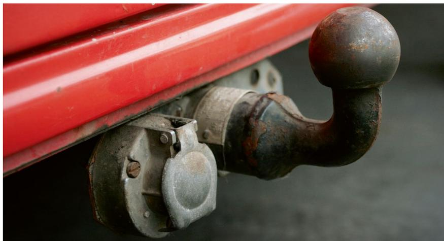
Von außen ist nur der Kupplungskopf zu sehen. Dahinter liegende Schäden bleiben unsichtbar.
