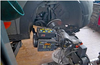
Für das Abdrehen einer Bremsscheibe benötigt die Maschine rund zehn Minuten.
